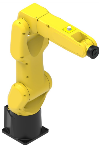
Payload 7kg : Fanuc LR Mate 200iD/7L
