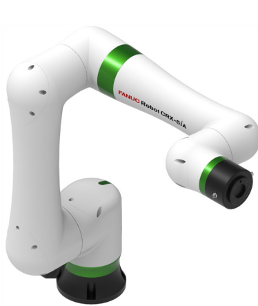
Payload 5kg : Fanuc CRX-5iA
