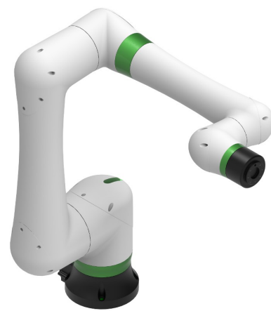
Payload 10kg : Fanuc CRX-10iA
